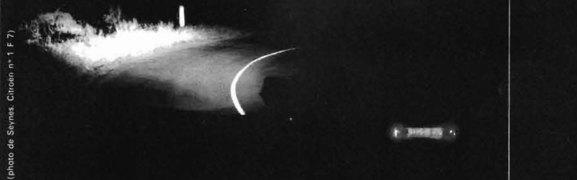
LES PHARES CLASSIQUES N'ÉCLAIRENT PAS LES VIRAGES NORMAL HEADLIGHTS DON'T LIGHT ROUND BENDS
